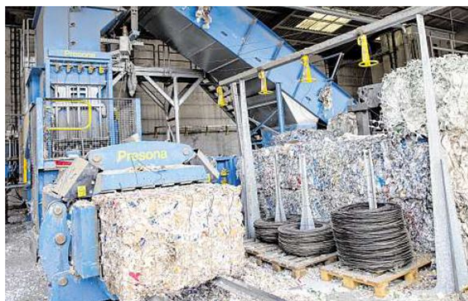
Geschreddertes Papier wird in der Entsorgungsfirma „Karl Fischer & Söhne“ zu bis zu 800 Kilogramm schweren Ballen gepresst und anschließend in nahe gelegene Papierfabriken transportiert.
